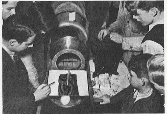
Strömungsbild an einem Flügelprofil
